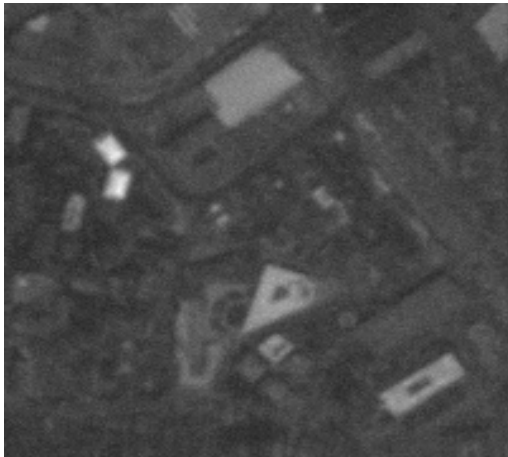
Рисунок 3. Мультипликативное искажение и Гауссов шум на тестовом изображении.
